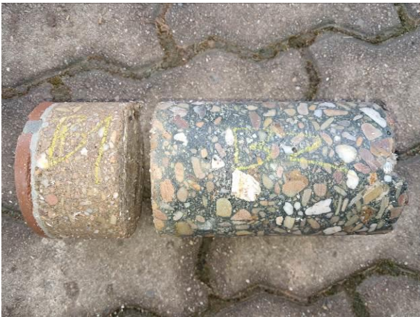
Foto 14: KB 1 Kernbohrung Fußboden
